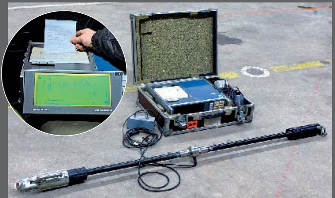
Das Equipment: Zugstange mit Kraftmessdose, Rechner mit Protokoll drucker
